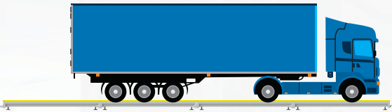
Bitrem, Rodotrem e Tritrem Até 36 m / 7 a 9 eixos
