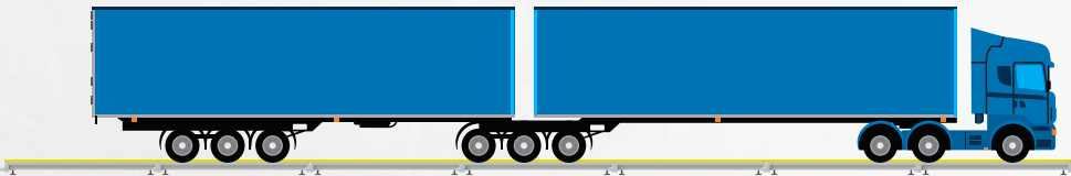
Tritrem e Especiais Até 60 m / 9 eixos acima
